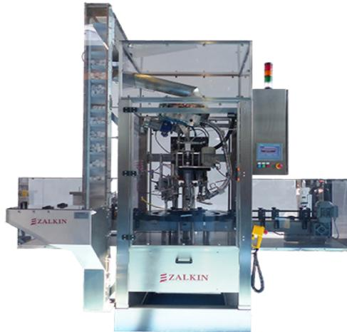
Este desarrollo conjunto entre **Pacific** y **Zalkin** es ideal para frascos de tamaño pequeño, con un diseño compacto integra el llenado y tapado de frascos en una sola máquina, evitando tener por separado el llenador, el transportador de frascos y luego la tapadora.
